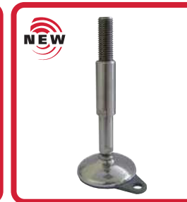
Part. R0750SF - Pág. R49 Ø 80 • Acero inox • Esterilizable • Predispuesto al fijado • Carga max. 25000 N.
