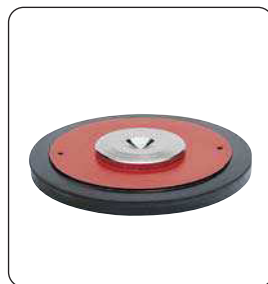
Part. R0187 - Pág. R59 Ø 123 • Goma con refuerzo en acero pintado • Carga max. 20000 N.
