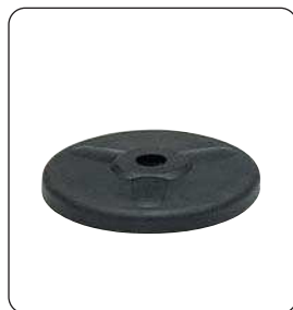
Part. R0055 - Pág. R59 Ø 110 • Goma con refuerzo en acero • Carga max. 6000 N.
