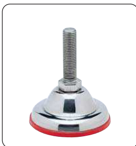
Part. R0399 - Pág. R56 Ø 90 • Acero inox • Esterilizable • Carga max. 11000 N.
