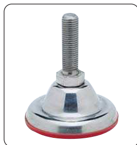
Part. R0385 - Pág. R56 Ø 110 • Acero inox • Esterilizable • Carga max. 10000 N.
