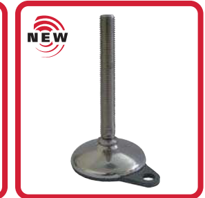
Part. R0748F - Pág. R45 Ø 100 • Acero inox • Esterilizable • Predispuesto al fijado • Carga max. 25000 N.
