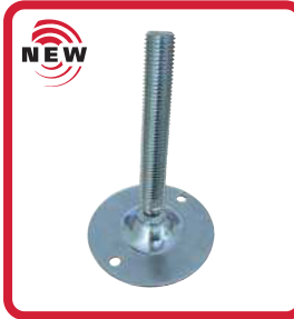
Part. R0441 - Pág. R41 Ø 123 • N. 2 agujeros • Acero zincado • Carga max. 10000 N.
