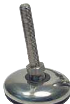
Part. R0623 - Pàg. R34 - R35 Ø 100 • Esterilizable • Personalizable con el logotipo • Carga max. 19500 N.
